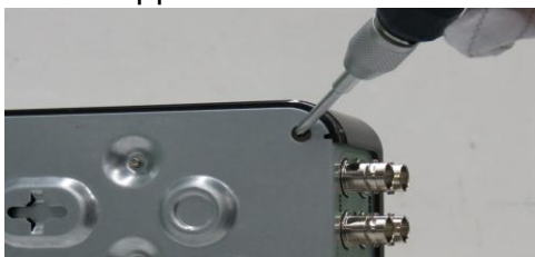
Открутите винты крепления крышки
