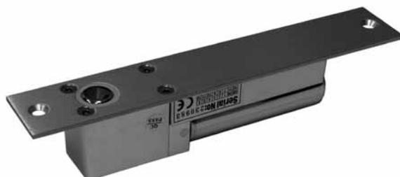
Электромеханический соленоидный замок ST-DB100M предназначен для работы в составе систем контроля доступа с электронным управлением блокировкой дверей. Замок ST-DB100M является нормально-открытым, т. е. он разблокируется при отключении электропитания и блокируется при его наличии. Специальный релейный выход замка позволяет системе контроля доступа выполнять мониторинг положения его прямого ригеля.
